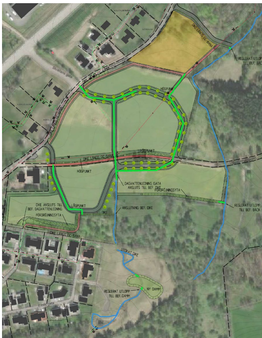
Utsnitt från förprojekterings tillhörande PM dagvatten som visar hur dagvatten är tänkt att hanteras inom planområdet.
