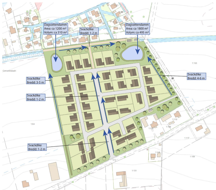
Illustration av föreslagen dagvattenhantering. I planförslaget reserveras ytor för dagvattenhantering på allmän med användningen Natur, och kommunalt huvudmannaskap. Dagvattenhantering föreslås hanteras genom svackdiken och fördröjningsanläggning (damm).
