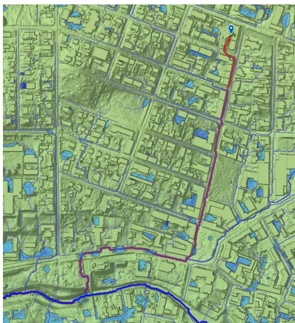
Utsnitt från SCLAGO som visar ytliga rinnvägar från planområdet till Hörbyån via befintliga gator med kommunalt huvudmannaskap.
