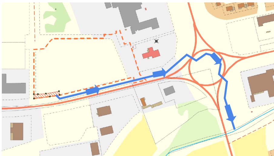
Karta som visar område som, med nuvarande markhöjder, riskerar att översvämmas i samband med intensiva regntillfällen (rött skrafferat område), ytliga rinnvägarna nedströms planområdet till Hörbyån (blå linje) och planområdesgräns (orange streckad linje).
