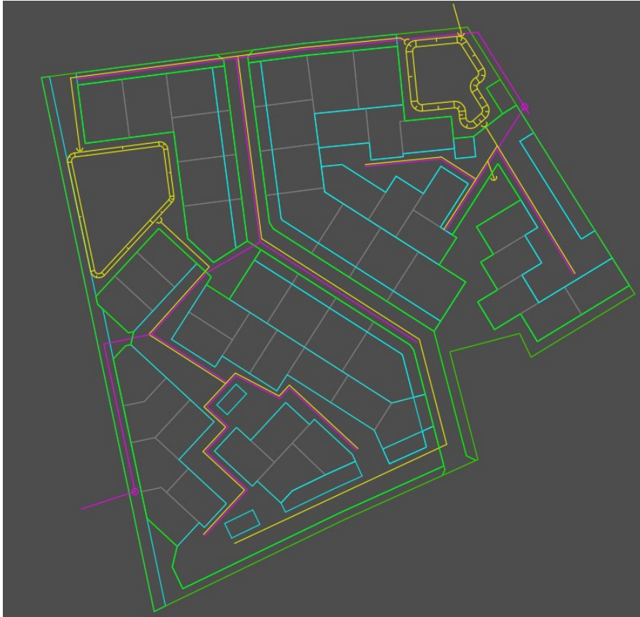
Principskiss spill- och dagvattensystemet. Grön = användningsgräns; magenta = spillvattenledning, schematiskt ritad; gul = dagvattenledning/damm, schematiskt ritad.
