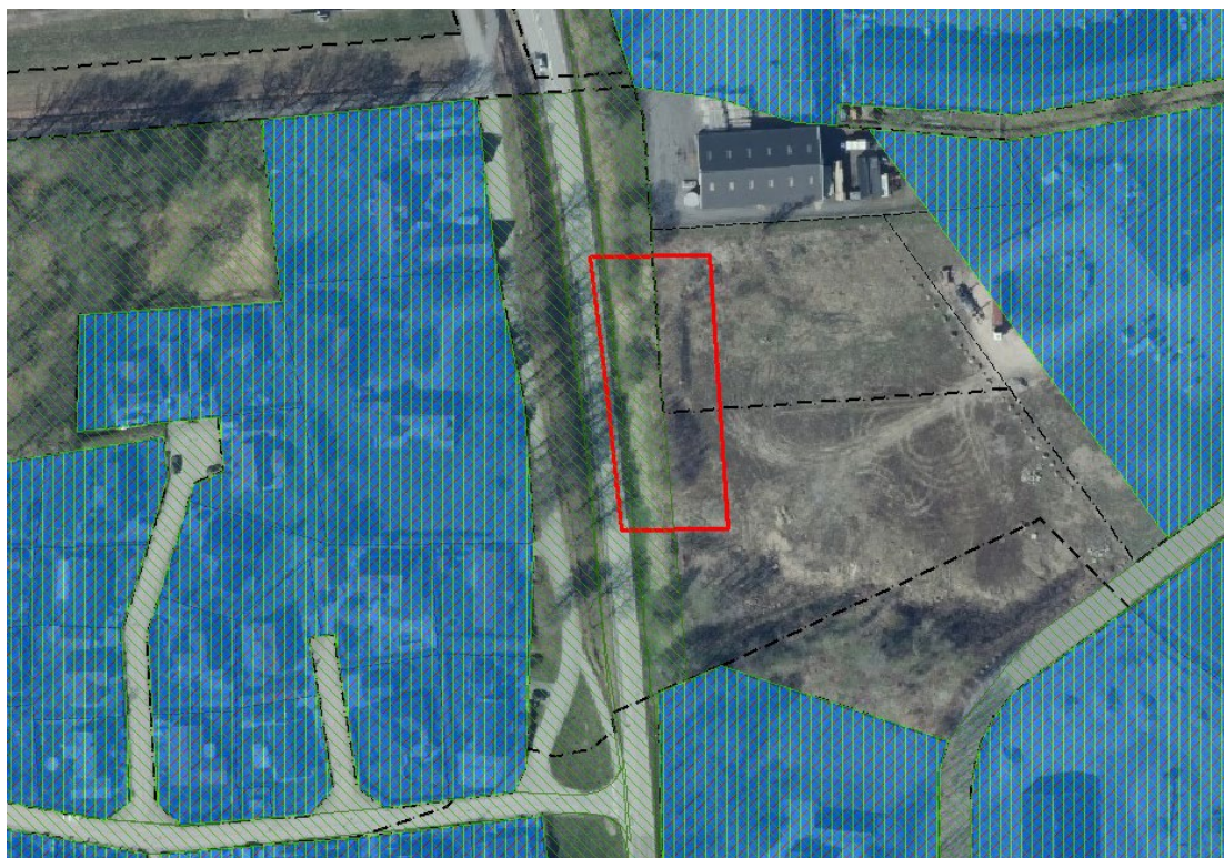
Bilden visar verksamhetsområden för VA inom och omkring planområdet. Grön skraffering visar verksamhetsområde Dagvatten gata (Dg).
