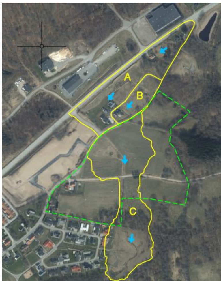
Figur 3.2 - Grön, streckad linje visar utredningsområdet. Befintliga avrinningsområden för befintlig dagvattendamm och bäck motsvaras av gul, heldragen linje.
