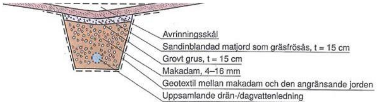
Figur 3.4 – Tvärsektion av gräsbesätt makadamdike
