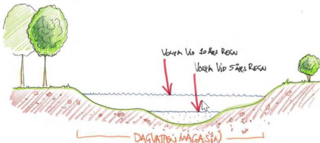
Figur 3.3.1 – principskiss dagvattendamm med terrass
