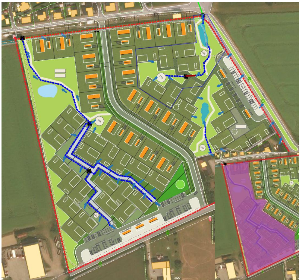
Figur 6.4 Hantering av dagvattenflöde i avrinningsområde Del 1
