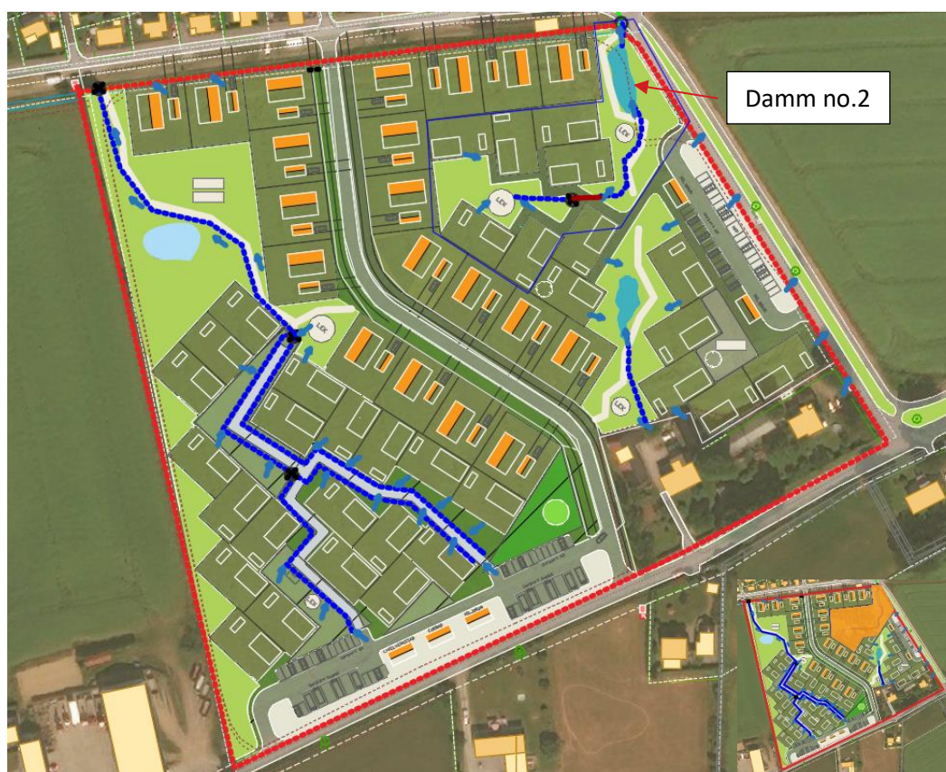
Figur 6.8 Hantering av dagvattenflöde i avrinningsområde Del 2
