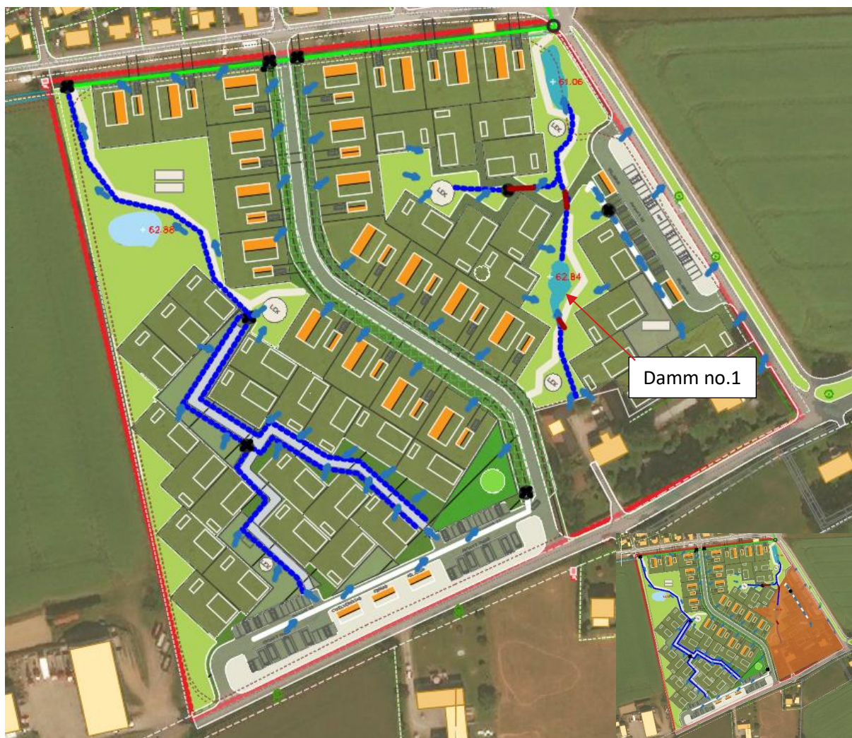
Figur 6.7 Hantering av dagvattenflöde i avrinningsområde Del 2
