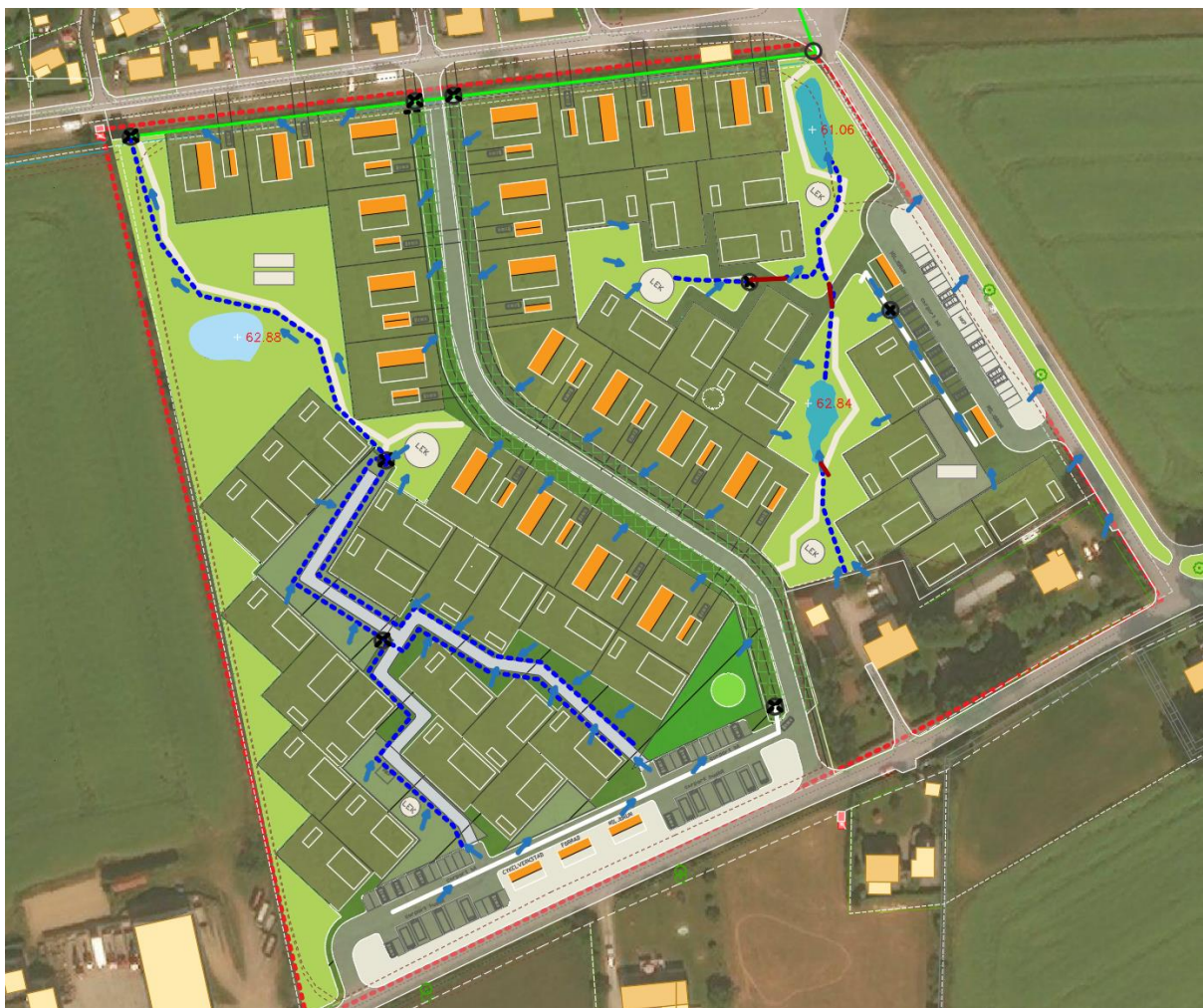
Figur 6.9 Hantering av dagvattenflöde i planerad Osbyholm avrinningsområde
