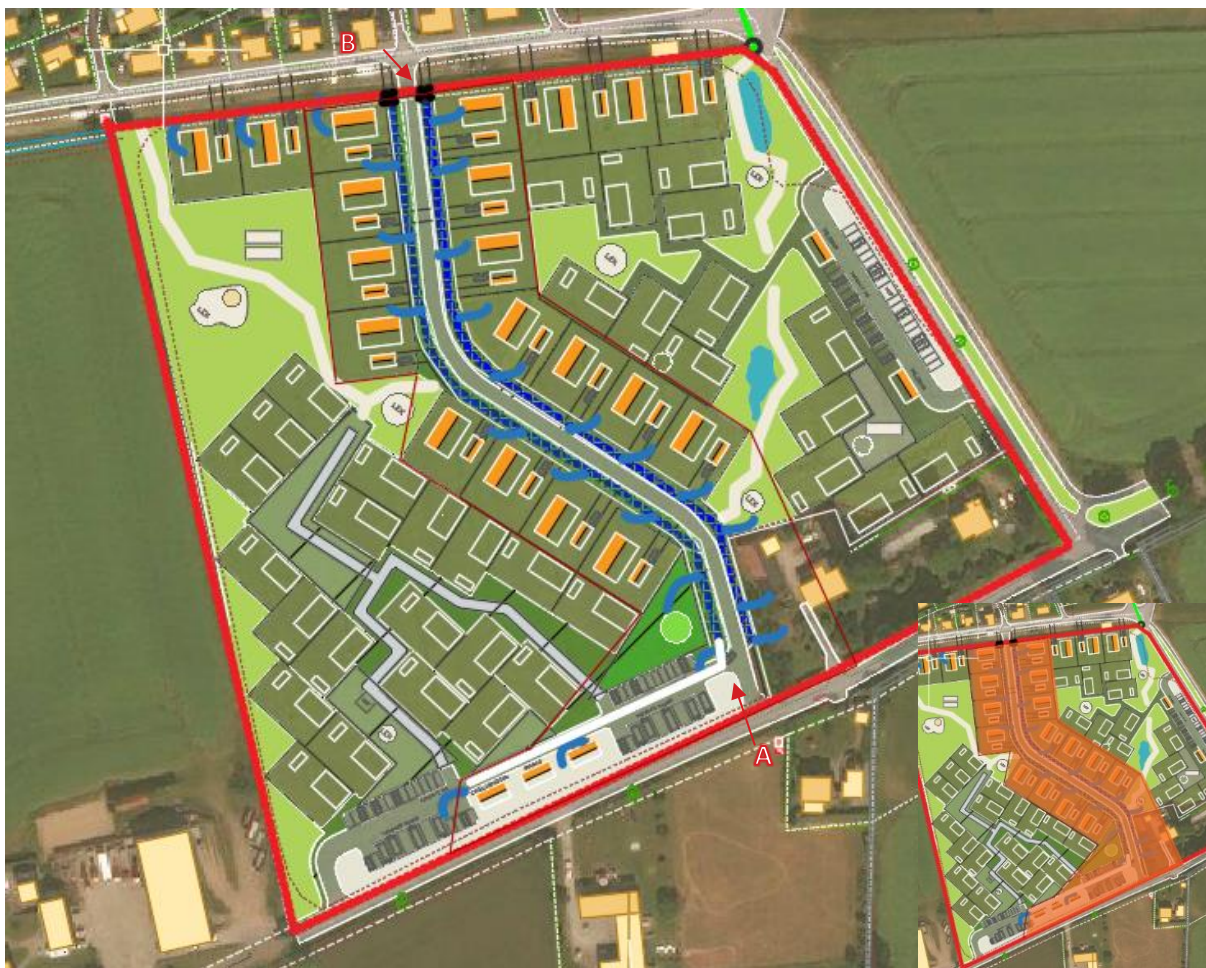
Figur 6.1 Hantering av dagvattenflöde i alternativ 1
