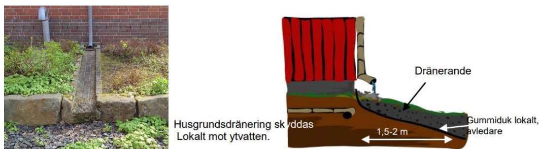
Figur. 5.4 Teknisk lösning för takvatteninfiltraion. Skyddar husgrunden.
